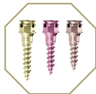
Los OrthoEasy® Pins disponen de un tornillo autoperforante y están codificados por colores para una rápida identificación de la longitud del tornillo. Los mini implantes vestibulares OrthoEasy® tienen una cabeza con diseño de bracket de doble slot cruz de .022" x .025" y una cavidad interior que permite usar alambres de hasta .019" x .025".
